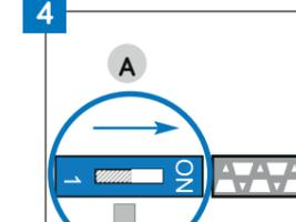
Pour passer en mode exploitation positionnez le switch sur "ON"
