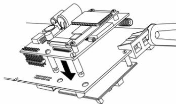
**2** **Colocación antena GSM**
