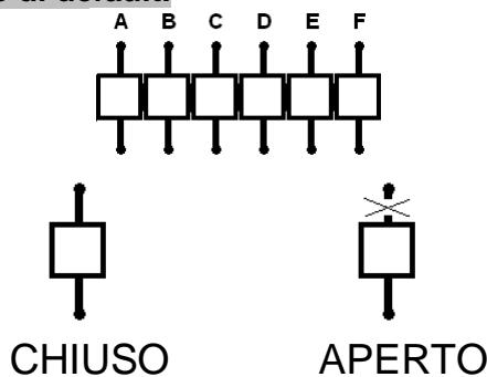
Il taglio dei ponticelli indicati con l'asterisco (\*), fa decadere la conformità alle norme EN50131.
