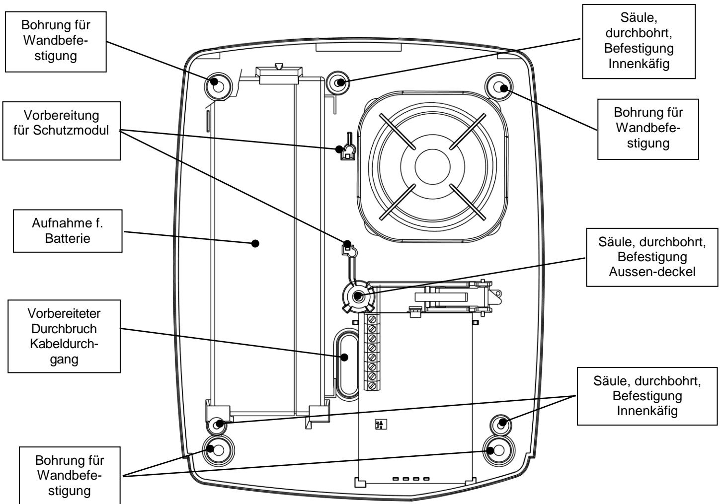
**⚠ Für die Verkabelung das abgeschirmte mehrpolige Kabel für die Einbruchssicherung verwenden.**
