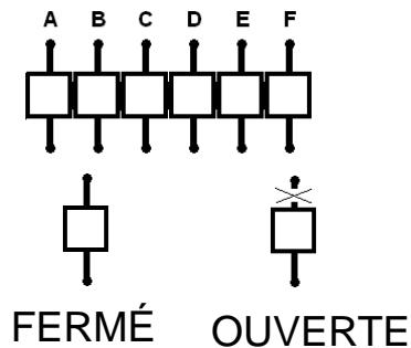
En conformité a les normes EN50131, les cavaliers marqués d'un astérisque (\*) doivent rester fermées.
