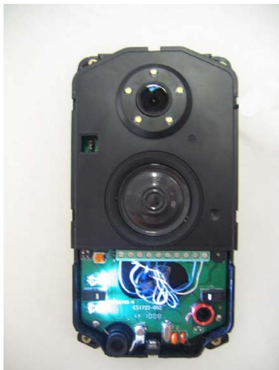
Remplacez la façade de la plaque MIKRA et vissez la vis située en partie basse à l'aide de la clé 6 pans fournie avec les accessoires du kit (clé de 2 mm)
