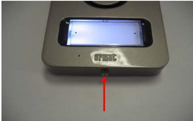
Déclipsez le couvercle du boîtier électronique à l'aide d'un tournevis plat de 4 mm
