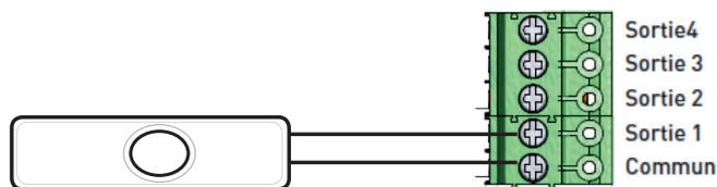
Il est également possible d'utiliser les sorties 2 à 4 pour le raccordement à la sonnette palière. Dans ce cas il sera nécessaire de configurer la sortie choisie dans le menu PARAMETRES\BOUTON SONNETTE PALIERE.
