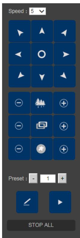
Sur cette interface, l'utilisateur peut contrôler la speed dome, modifier l'ouverture de l'iris, le zoom, la mise au point, la vitesse de Pan et Tilt. L'utilisateur peut également configurer ou sélectionner des Pré-réglages ou arrêter tous les tours
