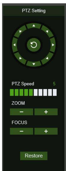
Sur la commande circulaire, il est possible de sélectionner 8 différents angles,
