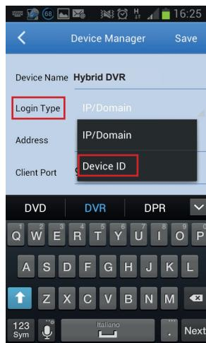
2. Complete el campo “Nombre de dispositivo” (Device Name) y haga clic en “Type” -> “Device Id” (Tipo -> ID de dispositivo).
