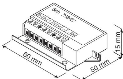
Le dispositif Réf.788/22 permet de réaliser la fonction de répétition de l'appel.
