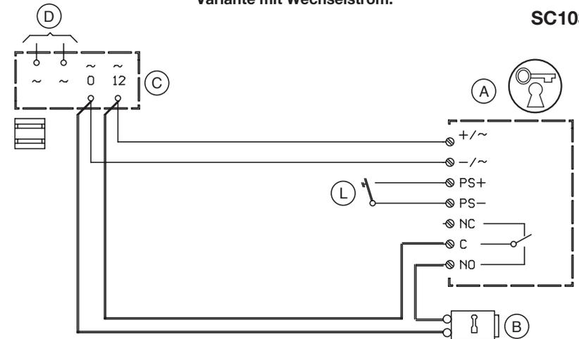
**Soluzione con alimentazione in c.c. con comando di una serratura di sicurezza.
