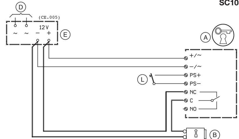
Soluzione con alimentazione in c.c. e con back-up tramite batteria e caricabatteria.
