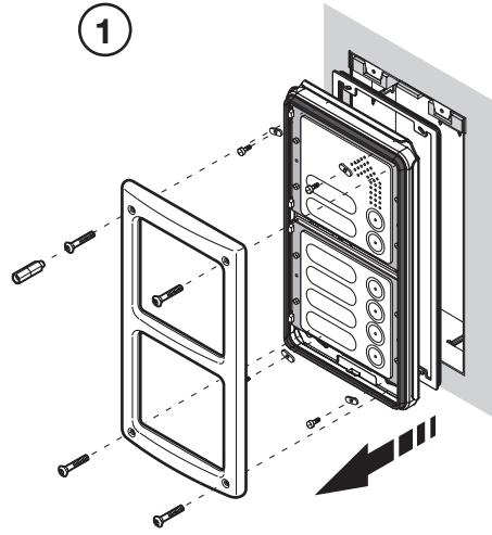
Smontare completamente la pulsantiera Mod.K-Steel
