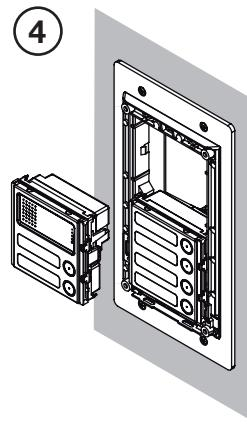
Fissare i moduli al telaio portamoduli ed eseguire i cablaggi
