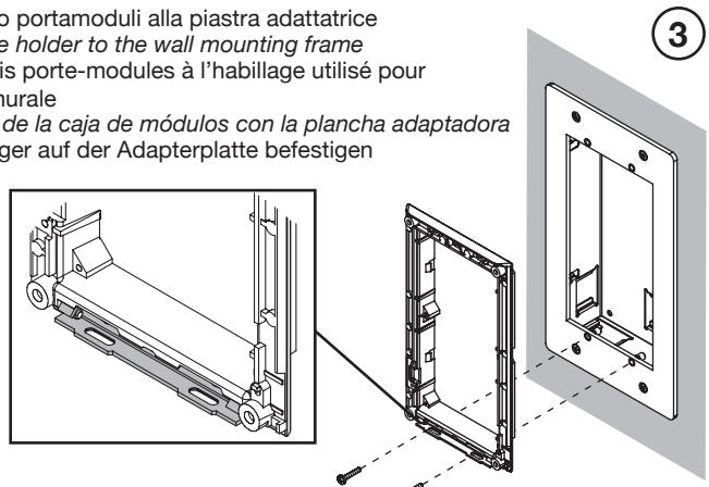
Fissare il telaio portamoduli alla piastra adattatrice
