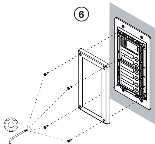
Montare la cornice sul telaio.
