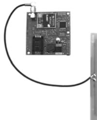
Interface qui permet la connexion des centrales MP500/8 et MP500/16 au réseau téléphonique mobile (GSM) pour envoyer des notifications d'alarme et recevoir des commandes distantes.
