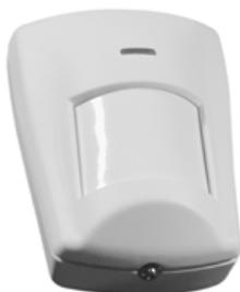
Détecteur à l'infrarouge passif pour détecter des mouvements dans la zone qu'il surveille et qui est conçu pour ne pas révéler des animaux pesant moins de 27 kg (Pet immunity).
