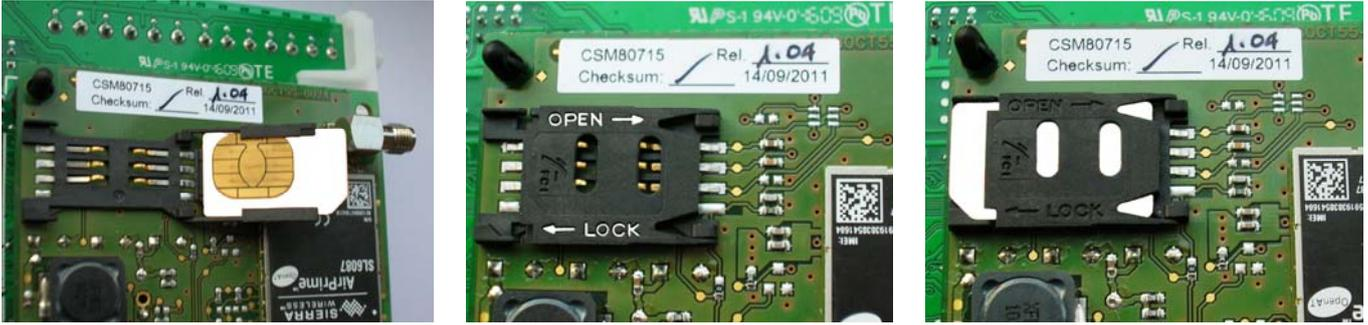
Figure 42 - Ouverture du boîtier SIM
