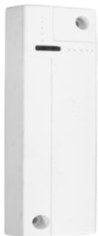
Détecteur à contact magnétique pour détecter l'état d'ouverture ou de fermeture de la porte ou de la fenêtre sur laquelle il est installé. Il dispose d'une entrée auxiliaire programmable, à laquelle il est possible de raccorder d'autres détecteurs NF (normalement fermés) ou un détecteur pour volet roulant.
