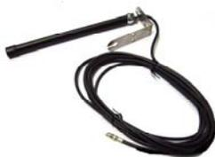
Antenne externe en option à utiliser avec le module GSM IMG500 si, en raison de l'emplacement de la centrale MP500/8 ou MP500/16, l'antenne interne fournie ne garantit pas au module un niveau de signal approprié.
