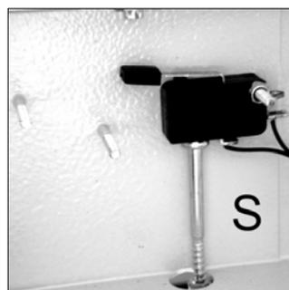
Figure 28 - Montage du tamper centrale MP500/16
