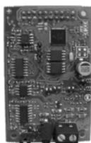
Module de synthèse vocale, pour les centrales MP500/8 et MP500/16, contenant des messages préenregistrés en italien, français et anglais, qui permet d'enregistrer et de réécouter des messages vocaux. Pour enregistrer des messages, on peut utiliser le clavier vocal avec afficheur KP500DV/N ou le microphone avec écouteur fourni avec l'équipement.
