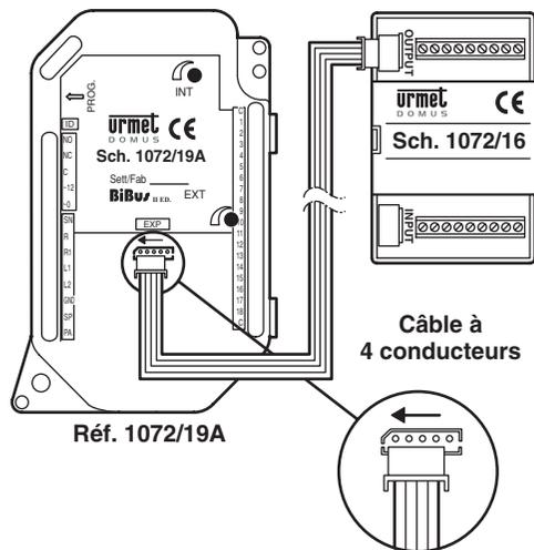
**N.B.:** Si le câble n'est pas engagé correctement, les touches associées aux modules d'expansion n'envoient pas l'appel.
