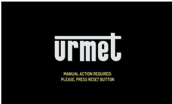
12. Dans ce cas, il est nécessaire d'utiliser à nouveau un outil pointu pour appuyer sur le bouton de redémarrage, présent dans le trou situé dans la partie inférieure droite du moniteur.
