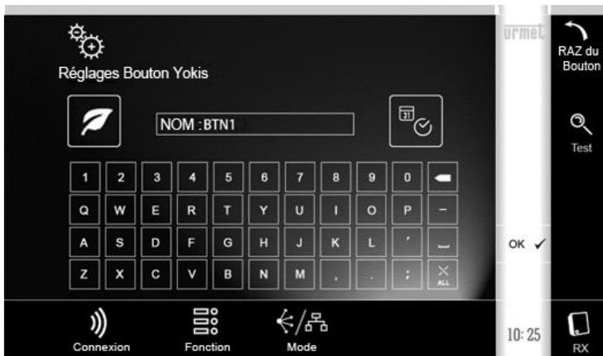
Après avoir attribué le nom au moyen du clavier, accéder aux icônes en bas qui permettent d'effectuer les mêmes configurations qui peuvent être effectuées sur un bouton d'un émetteur Yokis.
