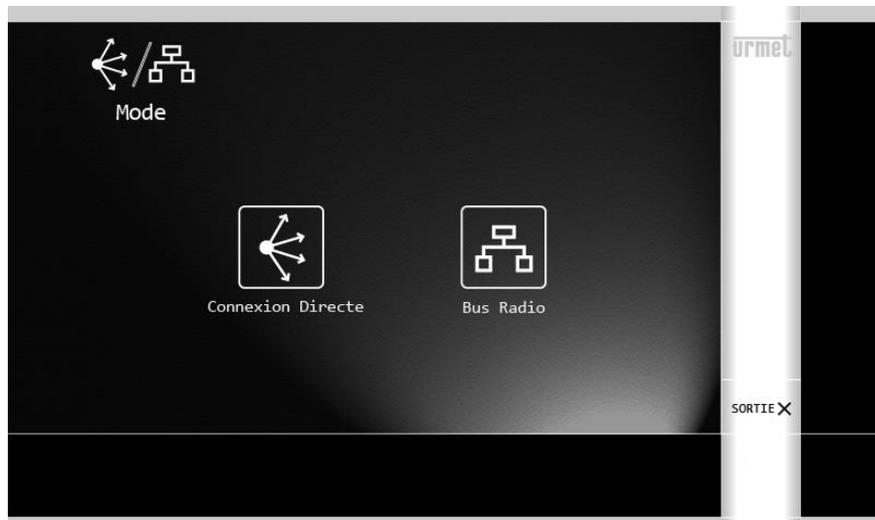
Si la modalité Bus Radio a été choisie, au niveau supérieur, une nouvelle icône s'affiche qui permet de sélectionner si la Centralisation agit sur l'Éclairage (par défaut) ou sur les Volets
