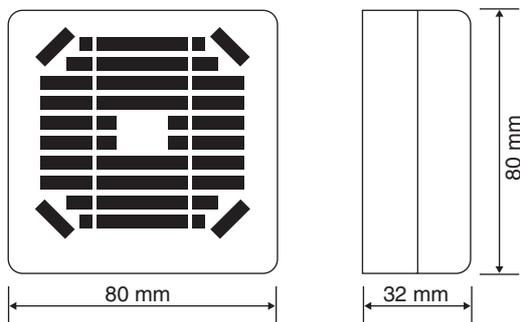
La sonnerie supplémentaire à trois tonalités Réf. 1072/59 peut être utilisée uniquement avec l'interphone confort Réf. 1172/32, l'interphone avec sélection des sonneries Réf. 1172/35, et la centrale Réf. 1072/41. Elle doit être forcément auto-alimentée (au moyen d'une batterie du type 6AM6-6LF22 de 9V), étant donné que le poste interne n'est pas en mesure de l'alimenter.
