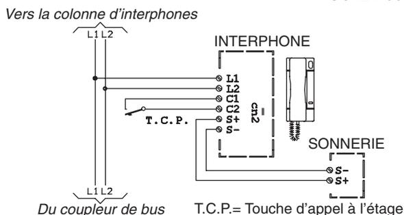
**Raccordement de la sonnerie sur une centrale.**
