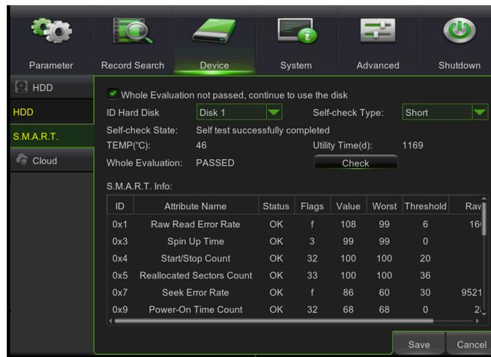
Le système **Self-Monitoring, Analysis, and Reporting Technology** ou **S.M.A.R.T.** est un système de monitoring pour disques durs et pour SSD, pour mesurer et fournir différents indicateurs de fiabilité pour anticiper les éventuels mauvais fonctionnements.
