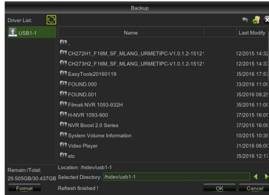
Sélectionner le dispositif de backup (par exemple clé USB ou Lecteur DVD USB) et le dossier de destination, appuyer sur [OK] pour lancer le backup, une barre d'avance est visualisée dans la partie inférieure de la fenêtre pour contrôler l'état d'avancement du backup.
