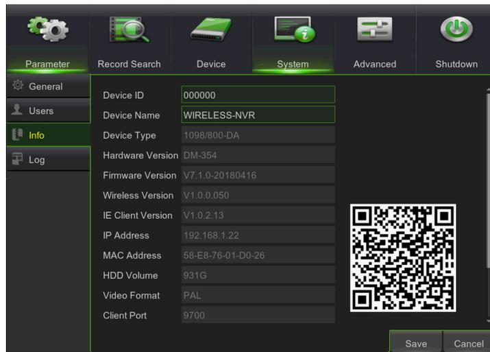
L'utilisateur peut contrôler les informations suivantes: Device name (Nom périphérique), Device ID (ID périphérique), Device type (Type périphérique), Hardware version (Version hardware), Firmware Version (Version firmware), IE Client version (Version Client IE), IP Address (Adresse IP), MAC address (Adresse MAC), etc.
