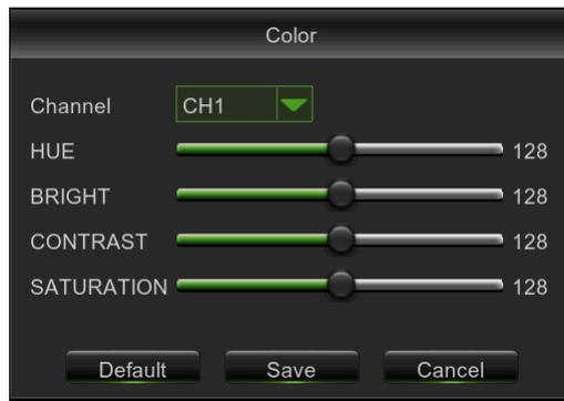
La figure ci-dessus reproduit le Color Menu (Menu Couleurs), dans lequel il est possible de régler les paramètres de luminosité, saturation, contraste, teinte et netteté de chaque canal.
