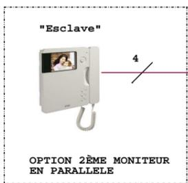
NOTA : METTRE LE SWITCH DES MONITEURS SUR LA POSITION "B" ET "VOP" SI PRESENT
