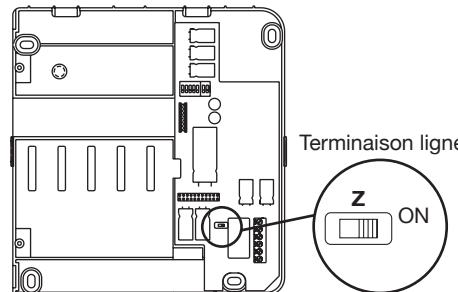
Les étries des internes comportent un interrupteur permettant d'insérer la terminaison de ligne. Il est nécessaire d'activer la terminaison dans tous les dispositifs câblés à la fin d'une ligne qui ne repart pas avec un autre segment des mêmes bornes du dispositif lui-même (fin de ligne):
