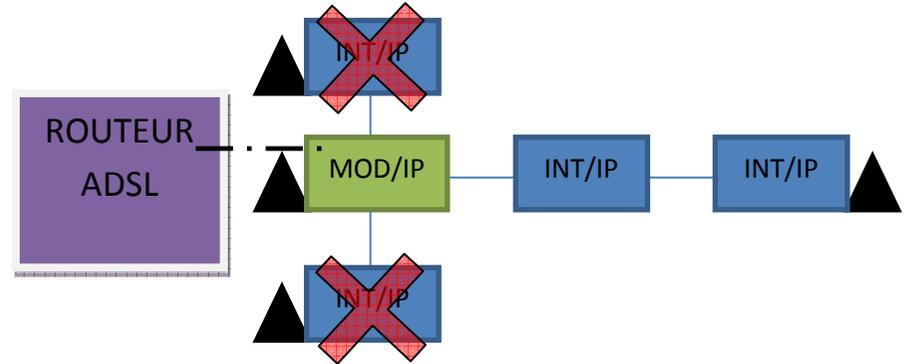
**CE MONTAGE EST INTERDIT, IL CONVIENT D'EFFECTUER LE MONTAGE CI-DESSOUS LORSQUE L'ON A BESOIN D'UNE 2<sup>e</sup> LIGNE 485**
