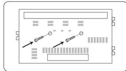
Placez le circuit électronique sur la base et le fixez
