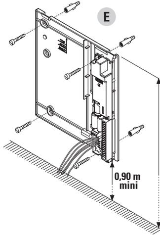
Hauteur d'installation recommandée conformément aux exigences de la loi accessibilité
