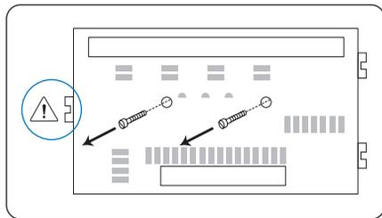
Enlevez les vis de fixation du circuit électronique
