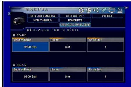
[1] RS-485: C'est pour le câblage du "Pupitre" ou de la télémétrie. Veuillez adapter les appareils raccordés à la vitesse réglée dans ce menu pour le Débit en Bauds / Parité / Bit de Stop.
