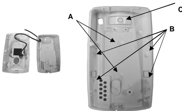
5. Quand la caméra est fixée et réglée correctement, remettez doucement le capot en le clipsant.
